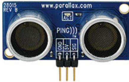
Figure 2.13: Parallax Ultrasonic PING))) sensor
