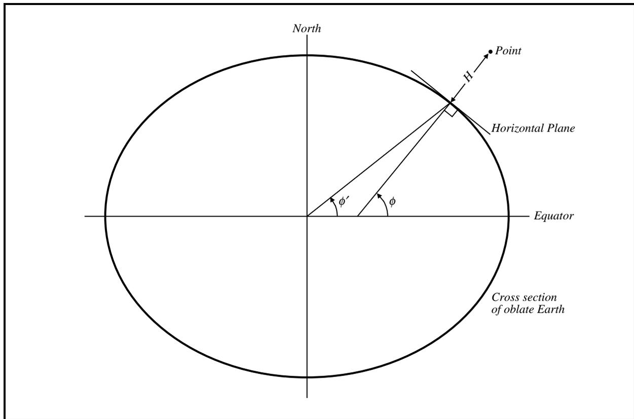
**Fig. 2.** Geodetic and Geometric latitude of a point.
