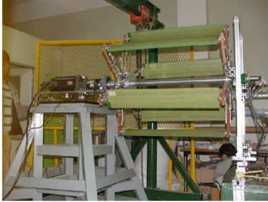
(a) Cyclorotor testing rig [28].
