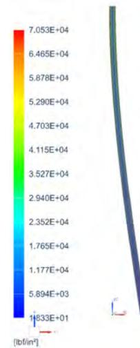
**Fig. 43 FEA of actuator rod**
