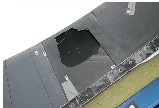
(d) Foam impact test on mock-up of a space shuttle leading edge
