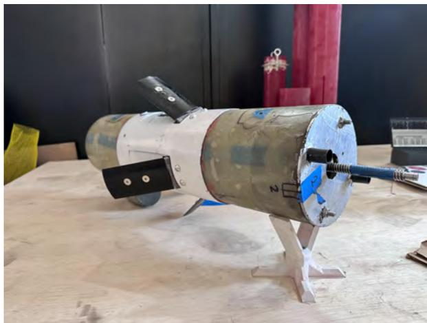
**Fig. 56 Air brake module**
