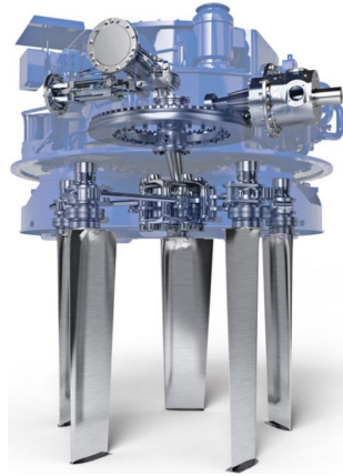
(a) Voith-Schneider propeller (VSP).
