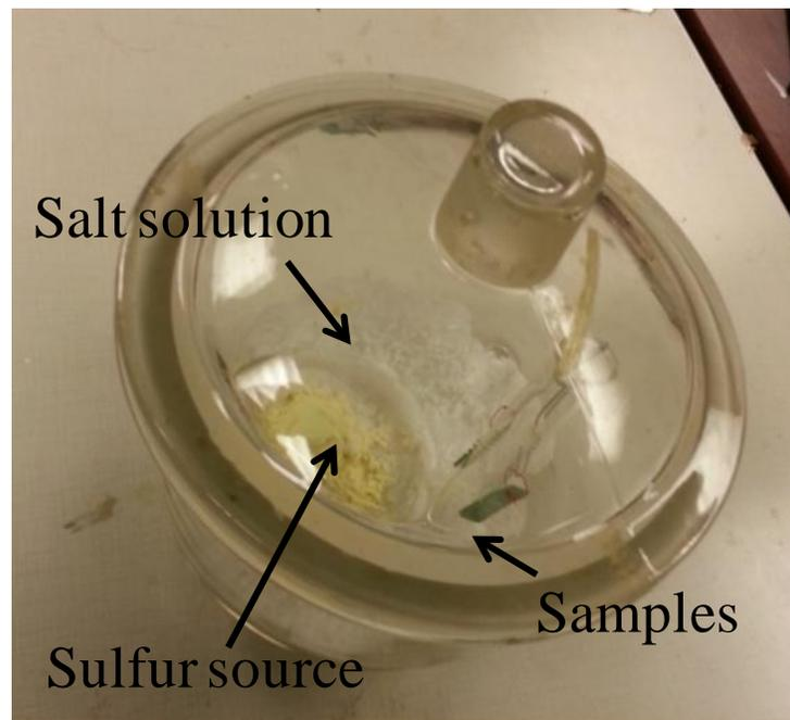
**Figure 17. FOS Test Vessel**
